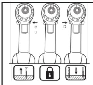
**6.** A engrenagem do meio pode ajustar a rotação para frente e para trás da máquina. Quando a engrenagem está na posição do meio, o interruptor estará travado.
