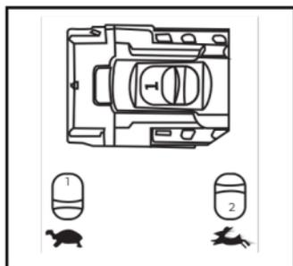
**8.** Se o modelo adquirido incluir a opção de ajuste de velocidade, a posição '1' corresponde à baixa velocidade com alto torque, enquanto a posição '2' oferece alta velocidade com baixo torque.
